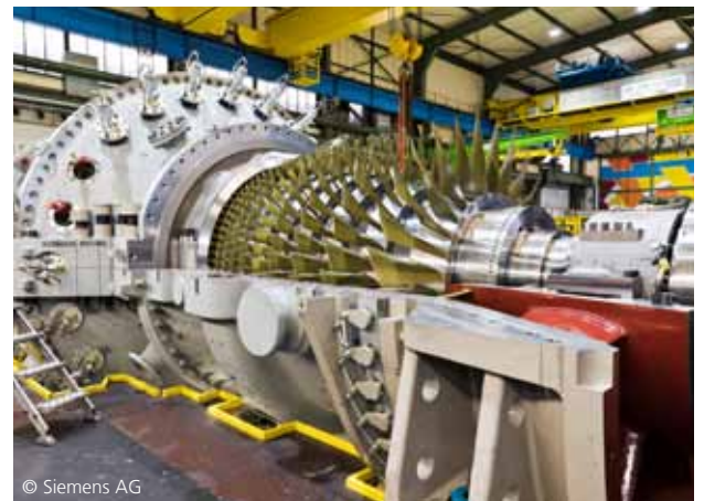
Die neue Siemens-Gasturbine des Typs SGT5-4000F des Kraftwerks King's Lynn
